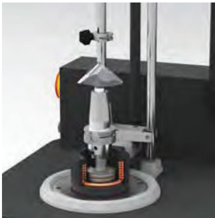
Bild1: Einsetzen Werkzeugträger Image1: Inserting tool adaptors
